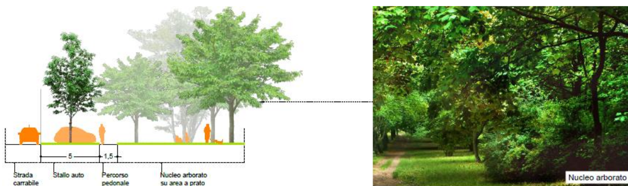
Figura 35: Sezione tipologica e riferimento fotografico della soluzione "Nucleo arborato"
