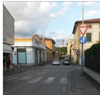
Incroccio Via G. Becagli – Via F. Filzi: segnaletica verticale troppo alta
