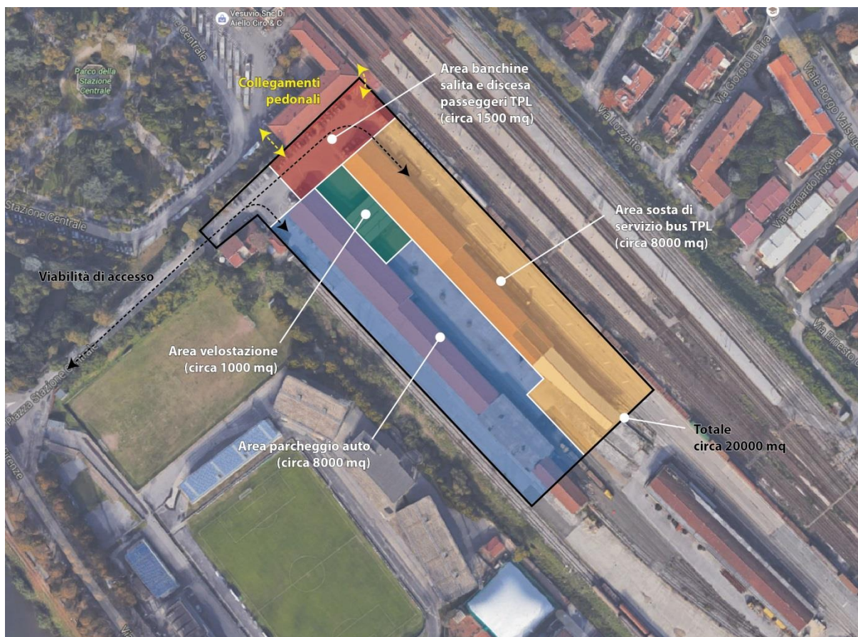
Figura 7-3: Centro intermodale (hub): schema delle funzioni e dimensionamento di massima
